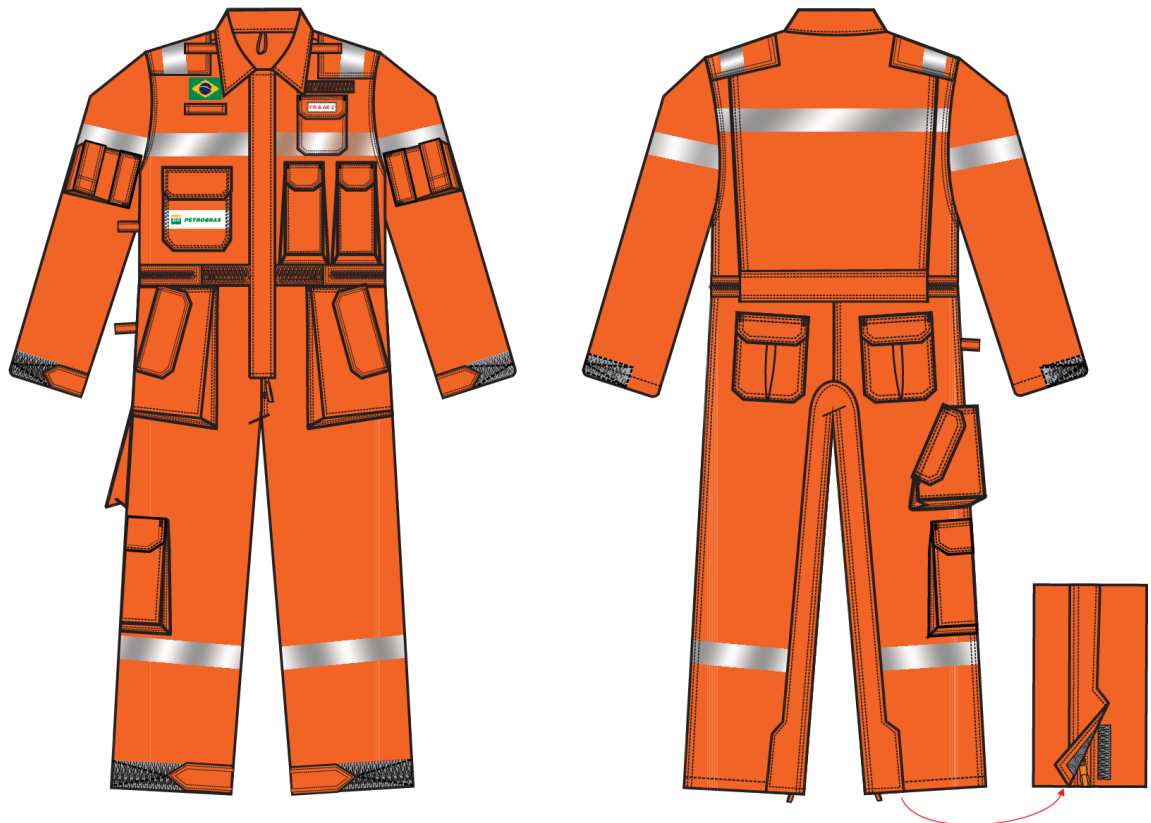
Figura 2 - Desenho técnico e detalhe dos passantes (vista esquerda da imagem) para o cabo de ligação do rádio trucker para o PTT com destaque para o zíper duplo com cursor destacável entre pernas e porta caderneta/caneta ambidestro
